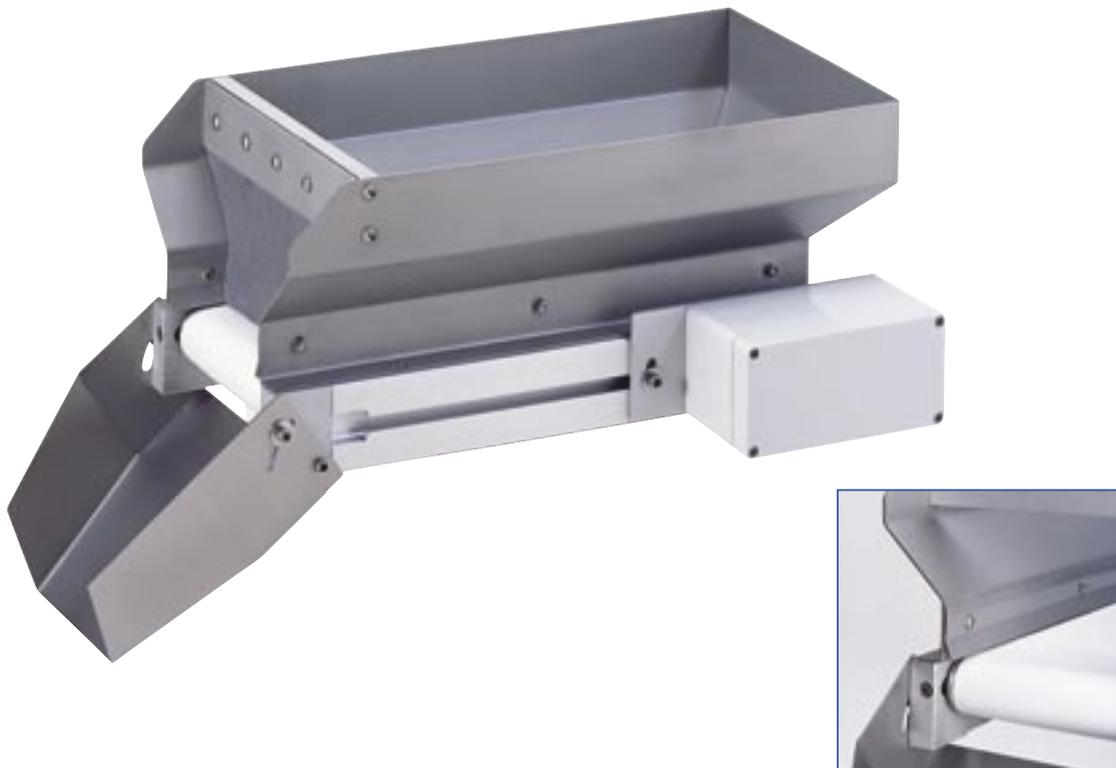
DasFröhlichBand Bandbunker sammeln und übergeben Teile gezielt zur weiteren Bearbeitung an Sortier- und Zuführgeräte. Damit verlängern sich die Nachfüllintervalle, können Arbeitsplätze sowie Maschinen mit hoher Dosiergenauigkeit beschickt und die Abmessungen der Geräte klein gehalten werden. Durch ihre vielseitigen Einsatzmöglichkeiten erhöhen sie die Produktivität und senken die Anlagekosten.
