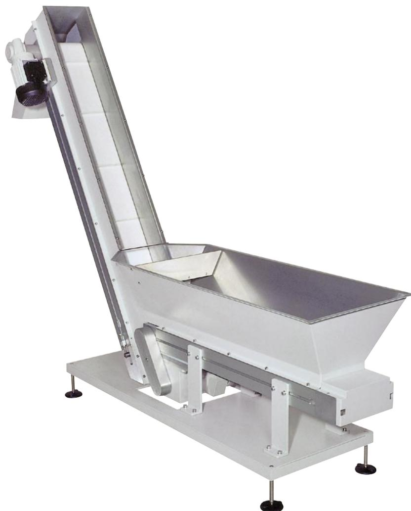
DasFröhlichBand Förderkombinationen bevorraten große Mengen sowie voluminöse Teile und beschicken Maschinen gezielt über das Steigband. Die hohe Dosiergenauigkeit wird über Freigabesignale der nachgelagerten Wendelförderer erreicht. Durch ihre ergonomischen Einfüllhöhen eignen sie sich aber auch als manuelle Pufferstrecke und schaffen an kritischen Stellen ausreichend Platz.
